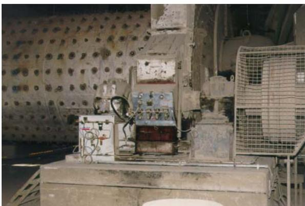
**Непосредственное размещение панели с форсунками для распыливания густой смазки позволят наносить смазку на наиболее нагруженную рабочую поверхность зуба шестерни- привода**
